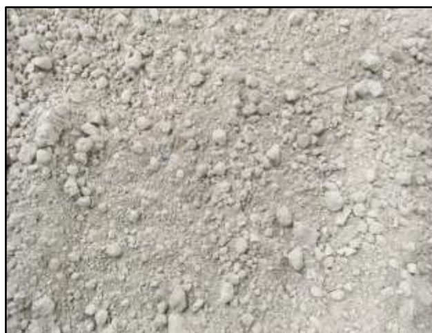
Figura 2. Resíduo do polimento de pisos de concreto na forma de pó.
